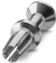
Crimpkontakt, Serie: HC-M-...-25, Buchse, gedreht, Kontaktdurchmesser: 6 mm, Anschlussquerschnitt: 10 mm<sup>2</sup> ... 10 mm<sup>2</sup>, AWG 8...8, Material Kontakt: Cu-Legierung
