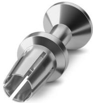
Crimpkontakt, Serie: HC-M-...-25, Buchse, gedreht, Kontaktdurchmesser: 6 mm, Anschlussquerschnitt: 6 mm<sup>2</sup> ... 6 mm<sup>2</sup>, AWG 10...10, Material Kontakt: Cu-Legierung
