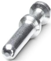
Crimpkontakt, Serie: HC-M-03, gedreht, Kontaktdurchmesser: 4 mm, Anschlussquerschnitt: 6 mm<sup>2</sup> ... 6 mm<sup>2</sup>, AWG 10...10, Material Kontakt: Cu-Legierung
