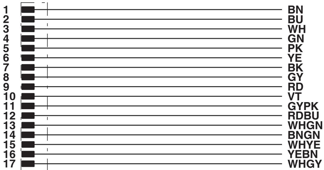
Kontaktbelegung des M12-Steckers
