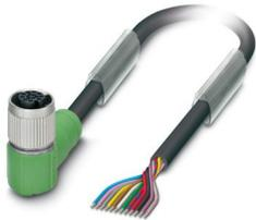
Sensor-/Aktor-Kabel, 12-polig, PVC, schwarz RAL 9005, freies Leitungsende, auf Buchse gewinkelt M12 SPEEDCON, Kodierung: A, Kabellänge: 1,5 m
