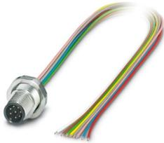
Gerätesteckverbinder Hinterwand, Universal, 8-polig, Stift, gerade, M12-Standard, A-Kodierung, auf freies Leitungsende, Einzellitzen, Kabellänge: 0,5 m, 0,25 mm<sup>2</sup>, TPE-Litze, vergossen, dieser Artikel ist voraussichtlich ab 2025-Q4 nach RoHS II ohne Ausnahme 6c (Pb < 0,1 %) bleifrei, auf Anfrage ist eine bleifreie Alternative vorab möglich
