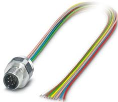
Gerätesteckverbinder Vorderwand, Universal, 8-polig, Stift, gerade, M12-Standard, A-Kodierung, auf freies Leitungsende, Einzellitzen, Kabellänge: 0,5 m, 0,25 mm<sup>2</sup>, TPE-Litze, vergossen, dieser Artikel ist voraussichtlich ab 2025-Q4 nach RoHS II ohne Ausnahme 6c (Pb < 0,1 %) bleifrei, auf Anfrage ist eine bleifreie Alternative vorab möglich
