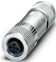
Datensteckverbinder, PROFINET CAT5 (100 MBit/s), 4-polig, geschirmt, Buchse gerade M12, Kodierung: D, Schneidklemmanschluss, Rändelmaterial: Messing, vernickelt, Leitungsaußendurchmesser 4 mm ... 8 mm
