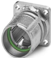
Gerätesteckverbinder-Gehäuse Vorderwand, Serie: M23 PRO Signal, gerade, für Standard- und ONECLICK-Schnellverriegelung, 4x Ø 2,7, Hinweis: nur in Kombination mit im Zubehör aufgeführten Kontakteinsätzen verwendbar; Sicherheitshinweise und Einbauanweisung siehe Referenzartikel 1629082 (Crimpversion) bzw. 1339329 (Lötversion)
