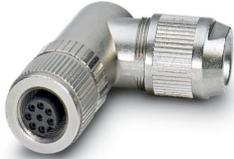
Datensteckverbinder, Ethernet CAT5 (1 GBit/s), 8-polig, geschirmt, Buchse gewinkelt M12, Kodierung: A, Schneidklemmanschluss, Rändelmaterial: Messing, vernickelt, Leitungsaußendurchmesser 4 mm ... 8 mm
