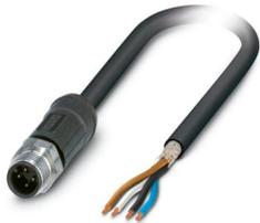
Sensor-/Aktor-Kabel, 4-polig, PE-X/PE-X halogenfrei, schwarzgrau RAL 7021, Stecker gerade M12, auf freies Leitungsende, Kabellänge: 24 m, für Außenanwendungen, mit Edelstahlrändel
