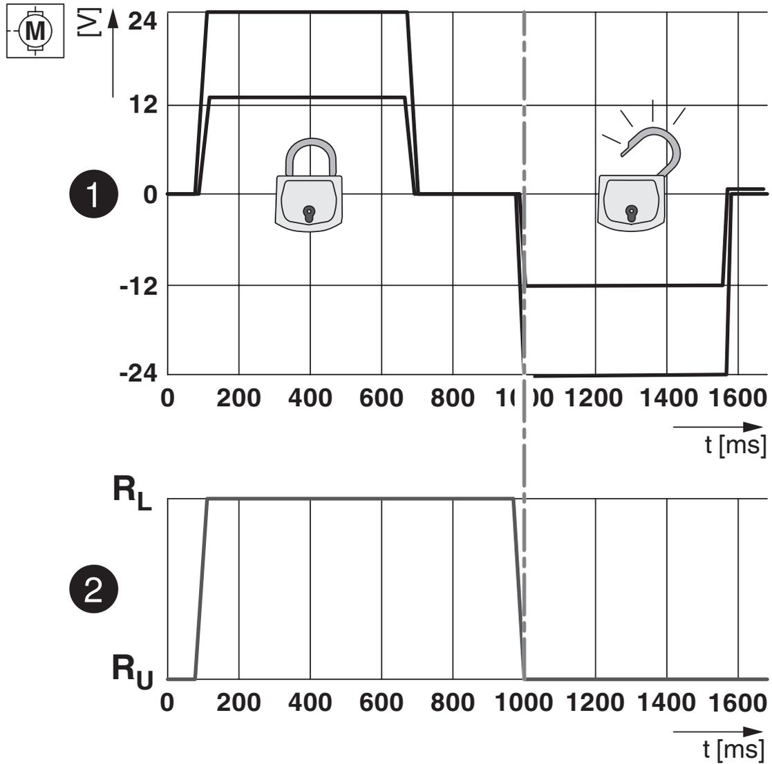
Verriegelungszustände des Verriegelungsaktuators
