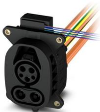
CHARX connect universal, AC/DC CCS Typ 1, Fahrzeug-Ladedose, bis zu 250 A im Boost Mode, 200 A dauerhaft, 1000 V DC, 80 A , 250 V AC, Einzelladern, Länge: 12 m, Verriegelungsaktuator: 12 V, 4-polig, Vorder- und Rückwandmontage, M6, Gehäuse: schwarz, zum Laden mit Wechselstrom (AC) und mit Gleichstrom (DC), IEC 62196-2, IEC 62196-3, Für die DC- und AC-Kontakte ist eine Schutzkappe im Lieferumfang enthalten.
