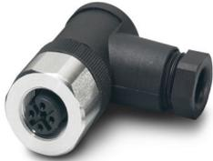
Steckverbinder, Universal, 5-polig, Buchse gewinkelt M12, Kodierung: A, Schraubanschluss, Rändelmaterial: Edelstahl 1.4404, Kabelverschraubung Pg7, Leitungsaußendurchmesser 4 mm .. 6 mm
