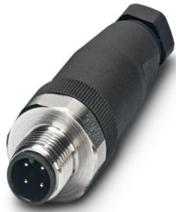
Steckverbinder, Universal, 4-polig, Stecker gerade M12, Kodierung: A, Schraubanschluss, Rändelmaterial: Edelstahl 1.4404, Kabelverschraubung Pg7, Leitungsaußendurchmesser 4 mm .. 6 mm
