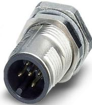
Gerätesteckverbinder Hinterwand, 5-polig, Stift, gerade, M12-SPEEDCON, A-Kodierung, Wellenlöten, dieser Artikel ist voraussichtlich ab 2026-Q2 nach RoHS II ohne Ausnahme 6c (Pb < 0,1 %) bleifrei, auf Anfrage ist eine bleifreie Alternative vorab möglich
