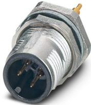
Gerätesteckverbinder Hinterwand, 4-polig, Stift, gerade, M12-SPEEDCON, A-Kodierung, Wellenlöt, dieser Artikel ist voraussichtlich ab 2026-Q2 nach RoHS II ohne Ausnahme 6c (Pb < 0,1 %) bleifrei, auf Anfrage ist eine bleifreie Alternative vorab möglich
