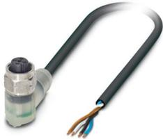
Sensor-/Aktor-Kabel, 4-polig, Spezialmischung auf PVC-Basis, schwarz RAL 9005, freies Leitungsende, auf Buchse gewinkelt M12, Kodierung: A, mit 3 LEDs, Kabellänge: 1,5 m, für die Lebensmittelindustrie, mit Edelstahlrändel
