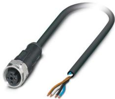
Sensor-/Aktor-Kabel, 4-polig, Spezialmischung auf PVC-Basis, schwarz RAL 9005, freies Leitungsende, auf Buchse gerade M12, Kodierung: A, Kabellänge: 3 m, für die Lebensmittelindustrie, mit Edelstahlrändel
