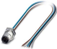
Gerätesteckverbinder Hinterwand, Universal, 5-polig, Stift, gerade, M12-SPEEDCON, B-Kodierung, auf freies Leitungsende, Einzellitzen, Kabellänge: 0,5 m, 0,34 mm<sup>2</sup>, TPE-Litze, vergossen, dieser Artikel ist voraussichtlich ab 2026-Q2 nach RoHS II ohne Ausnahme 6c (Pb < 0,1 %) bleifrei, auf Anfrage ist eine bleifreie Alternative vorab möglich
