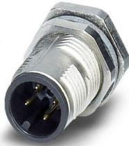
Gerätesteckverbinder Hinterwand, 4-polig, Stift, gerade, M12-SPEEDCON, A-Kodierung, Wellenlöten, dieser Artikel ist voraussichtlich ab 2026-Q2 nach RoHS II ohne Ausnahme 6c (Pb < 0,1 %) bleifrei, auf Anfrage ist eine bleifreie Alternative vorab möglich
