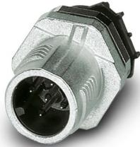
Gerätesteckverbinder Hinterwand, 5-polig, Stift, gerade, M12-SPEEDCON, A-Kodierung, THR-Lötanschluss, dieser Artikel ist voraussichtlich ab 2026-Q2 nach RoHS II ohne Ausnahme 6c (Pb < 0,1 %) bleifrei, auf Anfrage ist eine bleifreie Alternative vorab möglich
