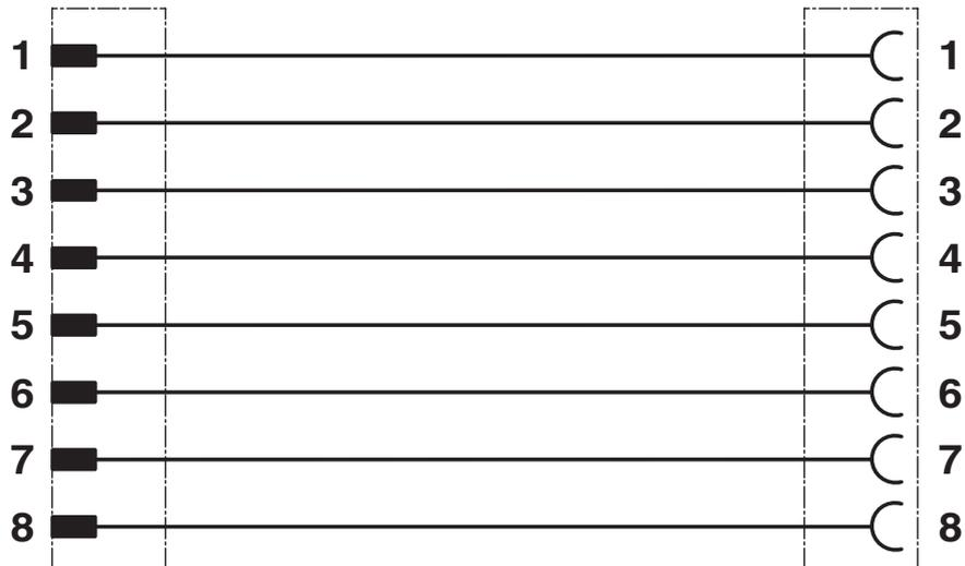
Kontaktbelegung des M12-Stecker und der M12-Buchse
