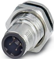
Gerätesteckverbinder Hinterwand, 4-polig, Stift, gerade, M12-SPEEDCON, D-Kodierung, Wellenlöten, 0,34 mm<sup>2</sup>, dieser Artikel ist voraussichtlich ab 2026-Q2 nach RoHS II ohne Ausnahme 6c (Pb < 0,1 %) bleifrei, auf Anfrage ist eine bleifreie Alternative vorab möglich
