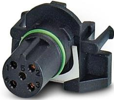
Kontaktträger, 5-polig, Buchse, gerade, M12, B-Kodierung, Wellenlöten, 0,34 mm<sup>2</sup>, dieser Artikel ist voraussichtlich ab 2026-Q2 nach RoHS II ohne Ausnahme 6c (Pb < 0,1 %) bleifrei, auf Anfrage ist eine bleifreie Alternative vorab möglich
