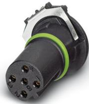
Kontaktträger, 5-polig, Buchse, gerade, M12, B-Kodierung, THR-Lötanschluss, dieser Artikel ist voraussichtlich ab 2026-Q1 nach RoHS II ohne Ausnahme 6c (Pb < 0,1 %) bleifrei, auf Anfrage ist eine bleifreie Alternative vorab möglich
