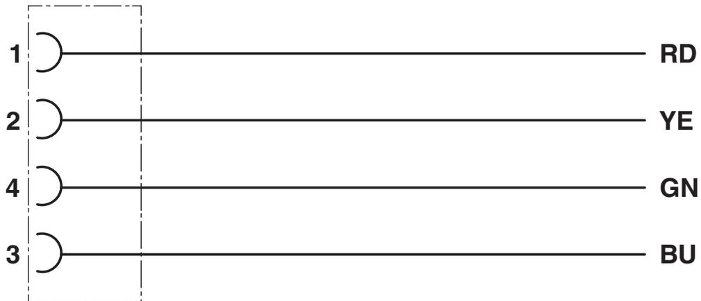
Kontaktbelegung der M8-Buchse
