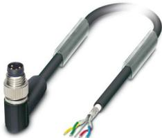
Bussystem-Kabel, INTERBUS, 4-polig, PUR halogenfrei, schwarz RAL 9005, geschirmt, Stecker gewinkelt M8, Kodierung: A, auf freies Leitungsende, Kabellänge: 2 m
