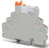
Vormontiertes Relaismodul mit Push-in-Anschluss, bestehend aus: Relaissockel mit Auswerfer und steckbarem Miniaturrelais mit Leistungskontakt und Handbetätigung. Kontaktausführung: 1 Wechsler. Eingangsspannung: 24 V DC
