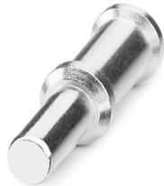
Crimpkontakt, Serie: HC-M-...-35, Stift, gedreht, Kontaktdurchmesser: 8 mm, Anschlussquerschnitt: 35 mm<sup>2</sup> ... 35 mm<sup>2</sup>, AWG 2...2, Material Kontakt: Cu-Legierung
