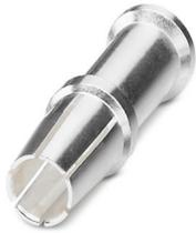
Crimpkontakt, Serie: HC-M-...-35, Buchse, gedreht, Kontaktdurchmesser: 8 mm, Anschlussquerschnitt: 35 mm<sup>2</sup> ... 35 mm<sup>2</sup>, AWG 2...2, Material Kontakt: Cu-Legierung
