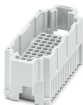
Leitungsverbinder, Polzahl: 71+PE, Anzahl der Anschlüsse je Pol: 1, Stift, Crimpanschluss, 250 V, 10 A, 0,14 mm<sup>2</sup> ... 2,5 mm<sup>2</sup>, für Steckverbindungen im Schaltschrank
