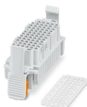
Leitungsverbinder, Polzahl: 71+PE, Anzahl der Anschlüsse je Pol: 1, Buchse, Crimpanschluss, 250 V, 10 A, 0,14 mm<sup>2</sup> ... 2,5 mm<sup>2</sup>, für Steckverbindungen im Schaltschrank
