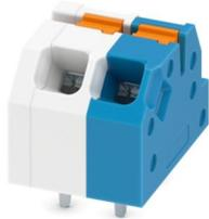
Leiterplattenklemme, Nennstrom: 16 A, Bemessungsspannung (III/2): 160 V, Nennquerschnitt: 1,5 mm<sup>2</sup>, Anzahl der Potenziale: 2, Anzahl der Reihen: 1, Polzahl pro Reihe: 2, Artikelfamilie: SPTAF 1/...-IL, Rastermaß: 3,5 mm, Anschlussart: Push-in-Federanschluss, Montage: Wellenlöten, Anschlussrichtung Leiter/Platine: 45 °, Farbe: mehrfarbig, Pin-Layout: Lineares Pinning, Pinlänge [P]: 2,6 mm, Anzahl der Lötpins pro Potenzial: 2, Verpackungsart: Tray
