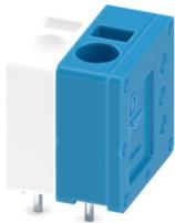
Leiterplattenklemme, Nennstrom: 24 A, Bemessungsspannung (III/2): 400 V, Nennquerschnitt: 2,5 mm<sup>2</sup>, Anzahl der Potenziale: 2, Anzahl der Reihen: 1, Polzahl pro Reihe: 2, Artikelfamilie: SPT 2,5/..-V, Rastermaß: 5 mm, Anschlussart: Push-in-Federanschluss, Montage: Wellenlöten, Anschlussrichtung Leiter/Platine: 90 °, Farbe: mehrfarbig, Pin-Layout: Lineares Pinning, Pinlänge [P]: 2,5 mm, Anzahl der Lötpins pro Potenzial: 2, Verpackungsart: verpackt im Karton
