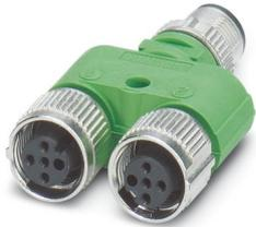
Y-Verteiler, 5-polig, Stecker gerade M12 SPEEDCON, Kodierung: A, auf Buchse gerade M12 SPEEDCON, Kodierung: A und Buchse gerade M12 SPEEDCON, Kodierung: A, parallel Verteiler, Gewinde M12-Buchse nicht drehbar
