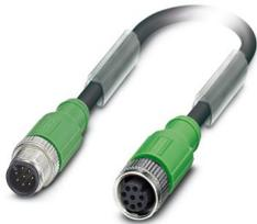
Sensor-/Aktor-Kabel, 8-polig, PUR, hochflexibel, grau RAL 7001, geschirmt, Stecker gerade M12, Kodierung: A, auf Buchse gerade M12, Kodierung: A, Kabellänge: 8 m
