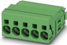
Leiterplattenstecker, Nennquerschnitt: 6 mm<sup>2</sup>, Farbe: grün, Nennstrom: 32 A, Bemessungsspannung (III/2): 1000 V, Kontaktoberfläche: Sn, Kontaktart: Stift, Anzahl der Reihen: 1, Polzahl: 4, Artikelfamilie: ISPC 5/...-STGCL, Rastermaß: 7,62 mm, Anschlussart: Push-in-Federanschluss, Anschlussrichtung Leiter/Platine: 0 °, Rasthaken: - ohne Rasthaken, Stecksystem: COMBICON PC 5, Verriegelung: Clipverriegelung, Befestigungsart: Click & Lock Rastfenster, Verpackungsart: verpackt im Karton
