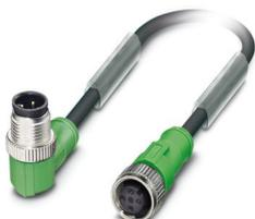
Sensor-/Aktor-Kabel, 4-polig, PUR halogenfrei, schwarzgrau RAL 7021, Stecker gewinkelt M12, Kodierung: A, auf Buchse gerade M12, Kodierung: A, Kabellänge: 5 m
