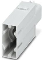
Kontakteinsatzmodul, Polzahl: 1, Leistungskontakte: 1, Steuerkontakte: 0, Stift, Crimpanschluss, 830 V, 100 A, 10 mm<sup>2</sup> ... 35 mm<sup>2</sup>, Anwendung: Leistung, ohne Crimpkontakte
