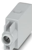
Kontakteinsatzmodul, Polzahl: 1, Leistungskontakte: 1, Steuerkontakte: 0, Buchse, Push-in-Anschluss, 830 V, 76 A, 2,5 mm<sup>2</sup> ... 16 mm<sup>2</sup>, Anwendung: Leistung
