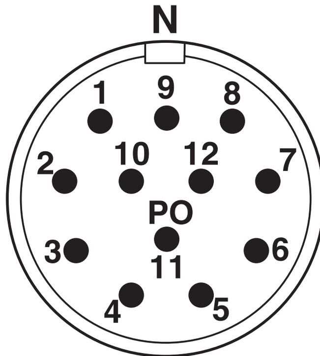
Kontaktkammernummerierung (Ansicht Steckseite) Stift Gegenlauf
