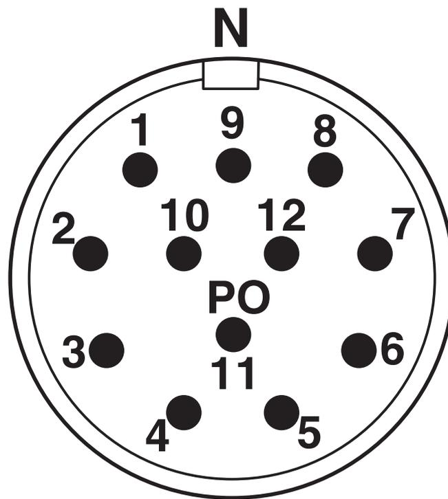
Kontaktkammernummerierung (Ansicht Steckseite) Stift Gegenlauf
