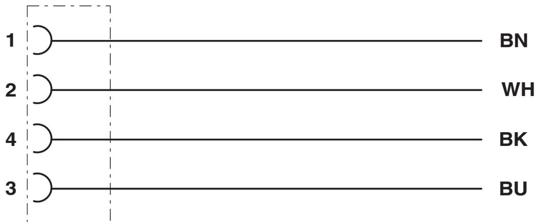
Kontaktbelegung der M8-/M12-Stecker/Buchsen
