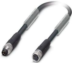
Bussystem-Kabel, INTERBUS, 4-polig, PUR halogenfrei, schwarz RAL 9005, geschirmt, Stecker gerade M8, Kodierung: A, auf Buchse gerade M8, Kodierung: A, Kabellänge: 5 m
