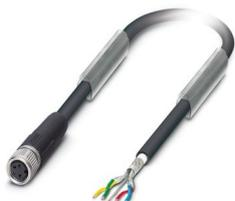
Bussystem-Kabel, INTERBUS, 4-polig, PUR halogenfrei, schwarz RAL 9005, geschirmt, freies Leitungsende, auf Buchse gerade M8, Kodierung: A, Kabellänge: 15 m
