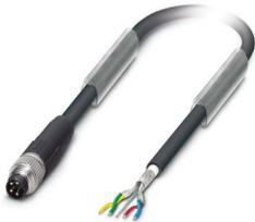
Bussystem-Kabel, INTERBUS, 4-polig, PUR halogenfrei, schwarz RAL 9005, geschirmt, Stecker gerade M8, Kodierung: A, auf freies Leitungsende, Kabellänge: 15 m
