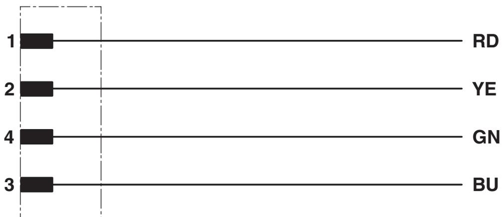
Kontaktbelegung des M8-Steckers
