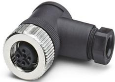
Steckverbinder, Universal, 4-polig, Buchse gewinkelt M12 SPEEDCON, Kodierung: A, Schraubanschluss, Rändelmaterial: Messing, vernickelt, Kabelverschraubung Pg7, Leitungsaußendurchmesser 4 mm ... 6 mm
