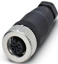
Steckverbinder, Universal, 4-polig, Buchse gerade M12 SPEEDCON, Kodierung: A, Schraubanschluss, Rändelmaterial: Messing, vernickelt, Kabelverschraubung Pg7, Leitungsaußendurchmesser 4 mm ... 6 mm
