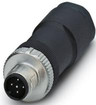
Steckverbinder, Universal, 5-polig, Stecker gerade M12 SPEEDCON, Kodierung: A, Schraubanschluss, Rändelmaterial: Zinkdruckguss, vernickelt, Kabelverschraubung Pg11-DUO, Leitungsaußendurchmesser 2,1 mm ... 3 mm / 4 mm ... 5,2 mm
