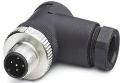
Steckverbinder, Universal, 5-polig, Stecker gewinkelt M12 SPEEDCON, Kodierung: A, Schraubanschluss, Rändelmaterial: Messing, vernickelt, Kabelverschraubung Pg9, Leitungsaußendurchmesser 6 mm ... 8 mm
