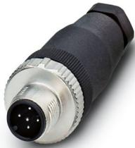
Steckverbinder, Universal, 5-polig, Stecker gerade M12 SPEEDCON, Kodierung: A, Schraubanschluss, Rändelmaterial: Zinkdruckguss, vernickelt, Kabelverschraubung Pg7, Leitungsaußendurchmesser 4 mm ... 6 mm
